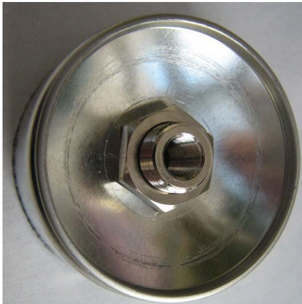
Außenansicht der Schraubbefestigung am Boden des Behälters
