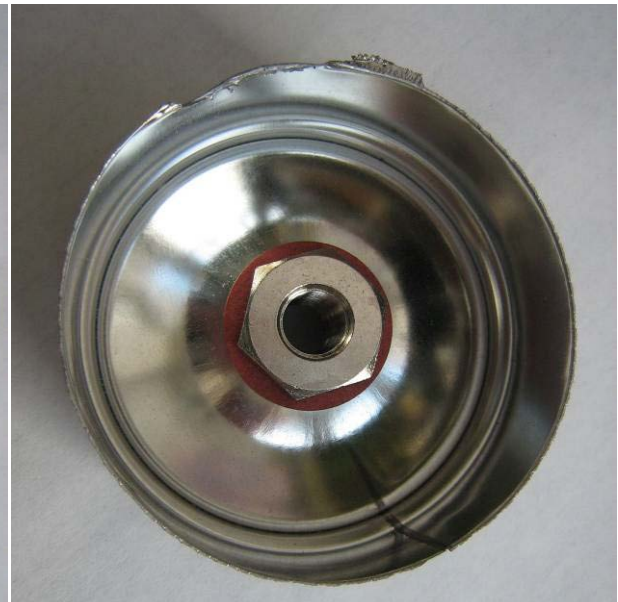
Innere Ansicht auf die Schraubbefestigung am Boden des Behälters
