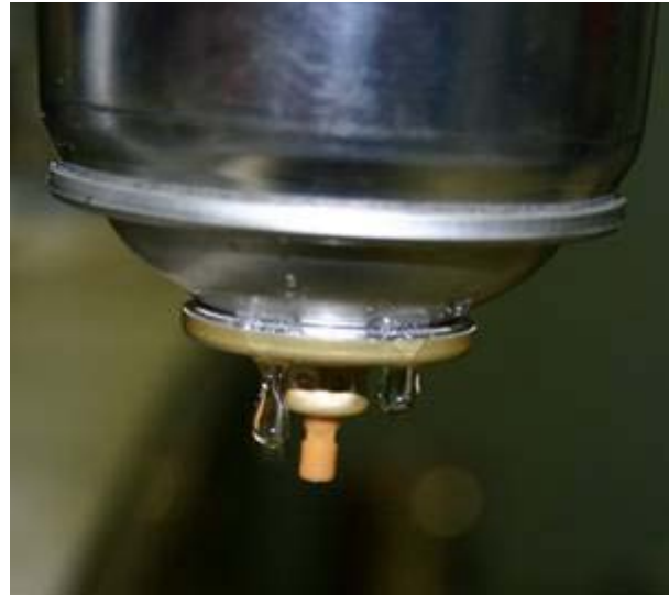
Fuite au niveau du dudgeonnage
