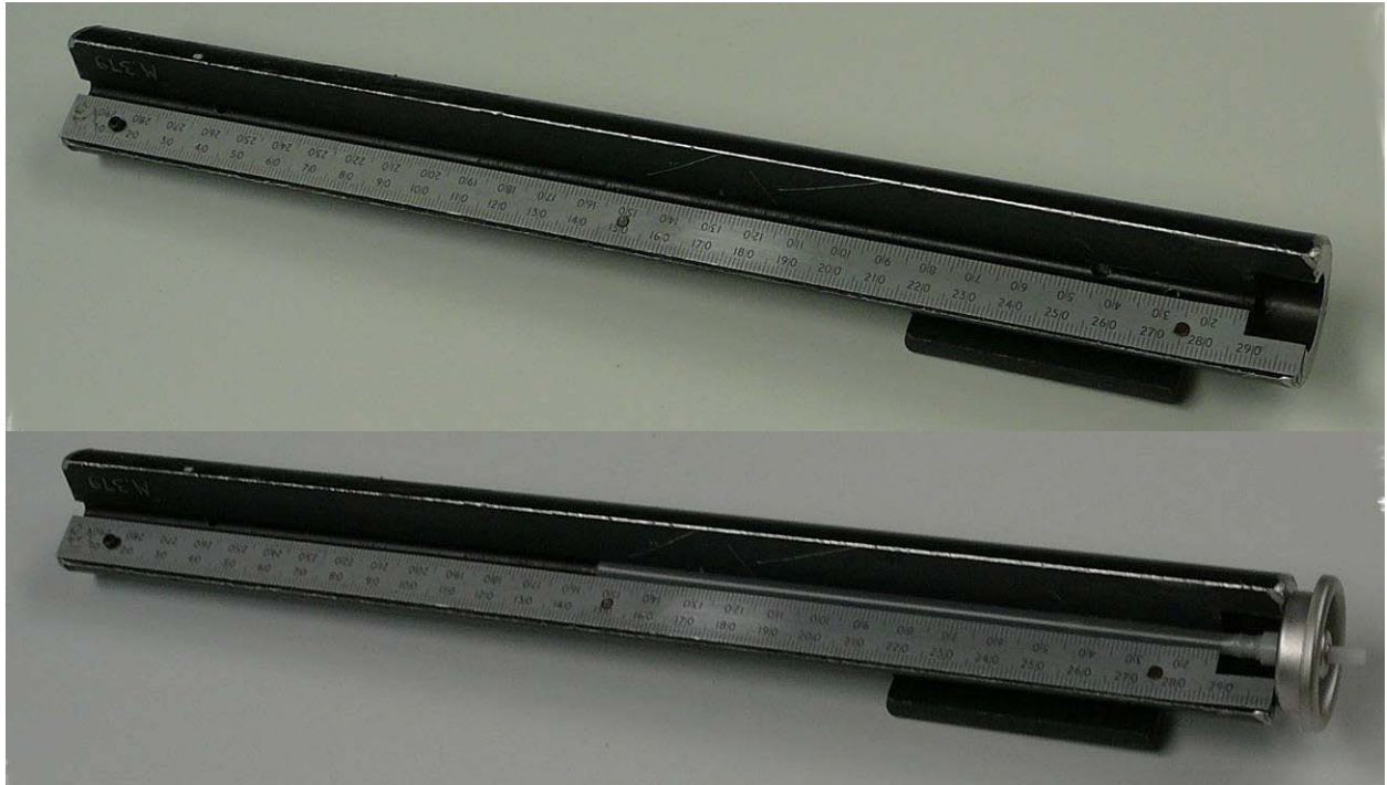
Abbildung 1: Messgerät für die Steigrohrlänge – Effektive Länge von der Formbasis
