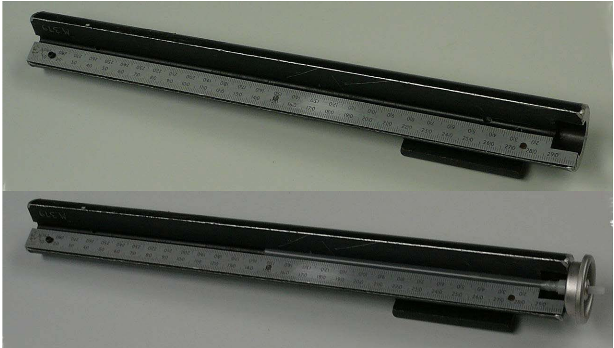
Figure 1: Instrument de mesure de la longueur d'un tube plongeur – Longueur utile à partir de la base de la coupelle
