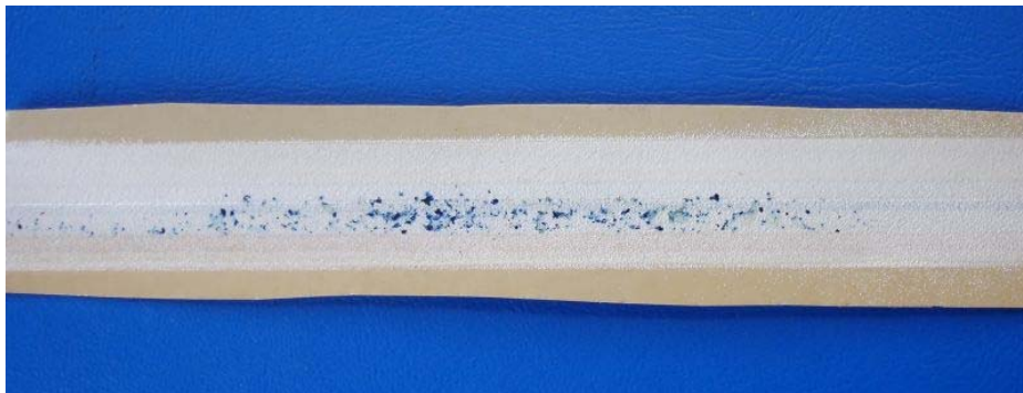
Exemple: Pores dans une bande latérale de poudre.
